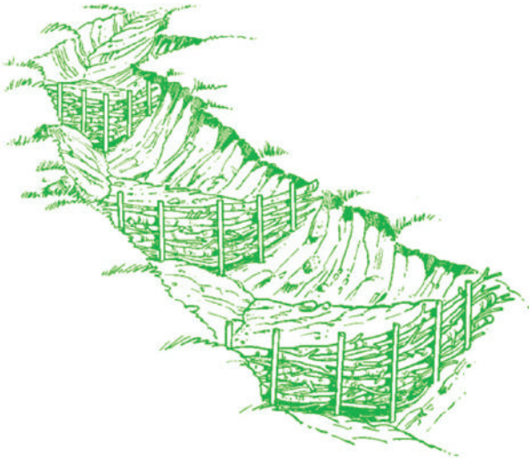
სურათი 16: ხევში ჩაშენებული ხის მესერი (Polster, 2003)
