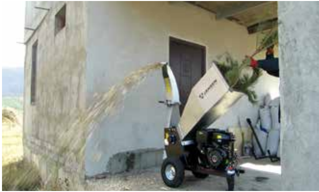
Պատկեր 6. Մուլչի պատրաստման սարքը պատրաստում է մուլչը՝ սանիտարական հատումների մնացորդներից
